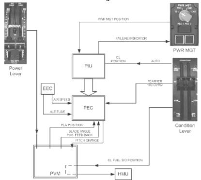
La commande de propulseur est hydromécanique commandé par une électrovanne de propulseur (PVM). Cette électrovanne est commandée par la commande électronique de propulsion (PEC) installée pour
