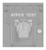
Il permet de vérifier le fonctionnement correct de l' ATPCS.
