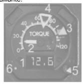
Si "---" sont affichés, c'est parce que l'EEC ne peut pas commander le Clapet de purge (HBV) Si "LAB" est affiché, c'est parce qu'un mauvais EEC est installé
